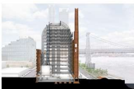
The Refinery at Domino. 1856年建築の米国最大の砂糖工場を外壁だけ保存し、内部にオフィスや住宅等の複合空間を建設。
